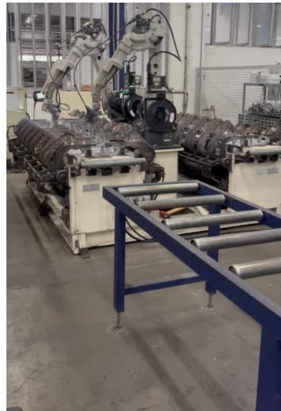
Soldadura robotizada y a fricción
